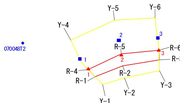
この図は、1/2500 地形図上で展開した、警戒区域・特別警戒区域について設定(基準)点及び下端(上端)位置の実測(計測)値から、平坦部の範囲について推計(展開)したものである。
