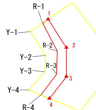
この図は、1/2500 地形図上で展開した、警戒区域・特別警戒区域について設定(基準)点及び下端(点)位置の実測(計測)値から、平坦部の範囲について推計(展開)したものである。
