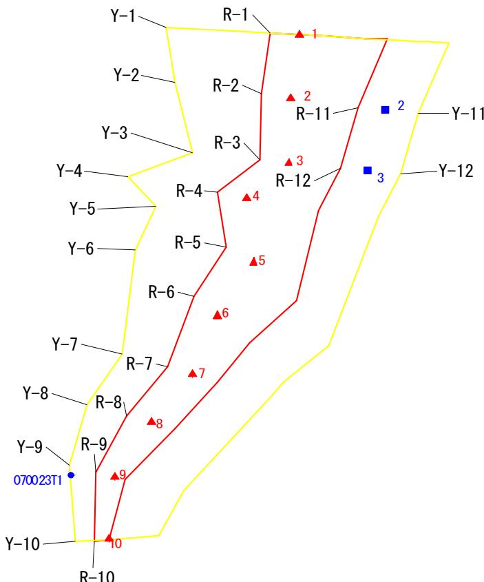
この図は、1/2500 地形図上で展開した、警戒区域・特別警戒区域について設定(基準)点及び下端(上端)位置の実測(計測)値から、平坦部の範囲について推計(展開)したものである。
