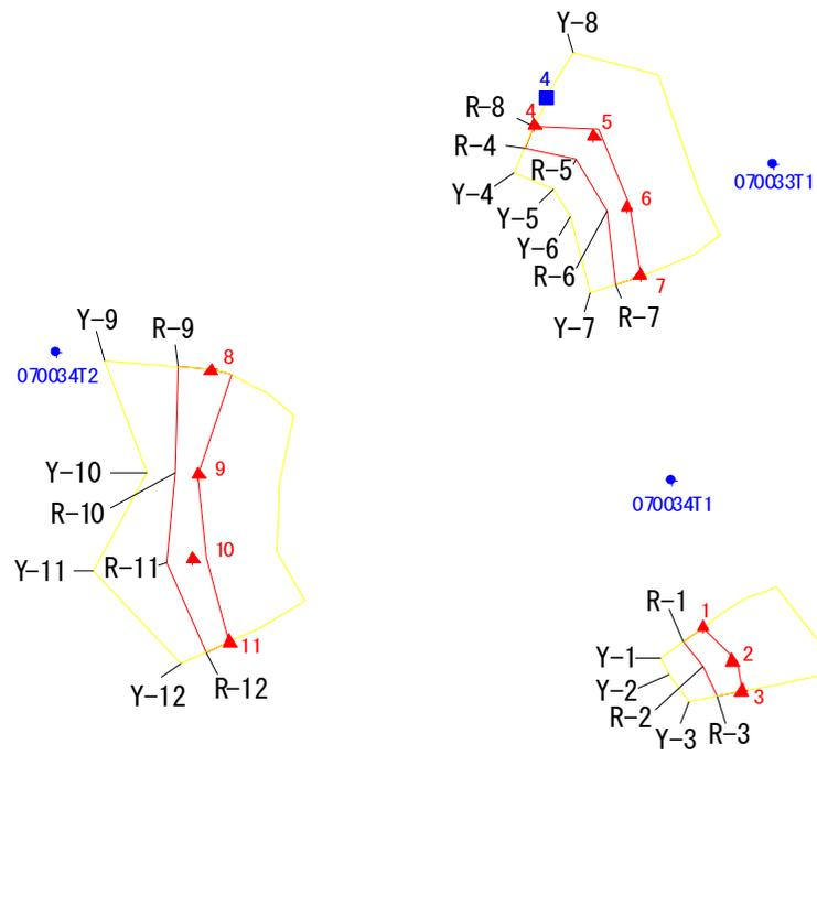
この図は、1/2500 地形図上で展開した、警戒区域・特別警戒区域について設定(基準)点及び下端(上端)位置の実測(計測)値から、平坦部の範囲について推計(展開)したものである。
