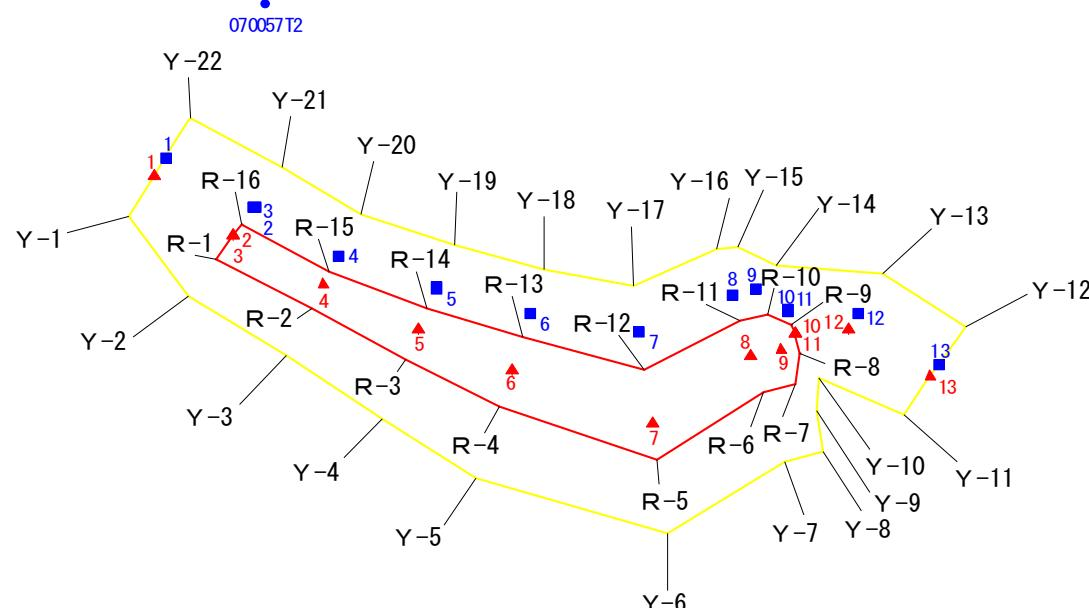
この図は、1/2500 地形図上で展開した、警戒区域・特別警戒区域について設定(基準)点及び下端(上端)位置の実測(計測)値から、平坦部の範囲について推計(展開)したものである。
