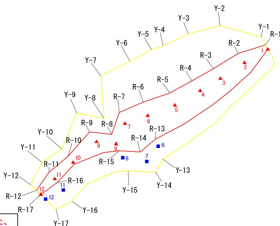
この図は、1/2500 地形図上で展開した、警戒区域・特別警戒区域について設定(基準)点及び下端(上端)位置の実測(計測)値から、平坦部の範囲について推計(展開)したものである。
