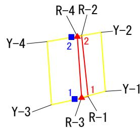
この図は、1/2500 地形図上で展開した、警戒区域・特別警戒区域について設定(基準)点及び下端(上端)位置の実測(計測)値から、平坦部の範囲について推計(展開)したものである。
