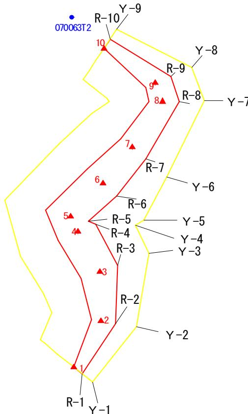
この図は、1/2500 地形図上で展開した、警戒区域・特別警戒区域について設定(基準)点及び下端(上端)位置の実測(計測)値から、平坦部の範囲について推計(展開)したものである。
