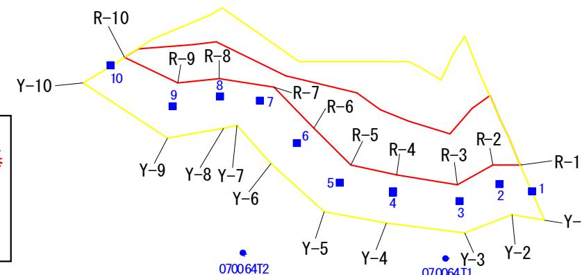
この図は、1/2500 地形図上で展開した、警戒区域・特別警戒区域について設定(基準)点及び下端(上端)位置の実測(計測)値から、平坦部の範囲について推計(展開)したものである。
