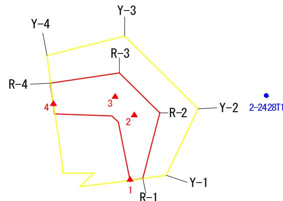
この図は、1/2500 地形図上で展開した、警戒区域・特別警戒区域について設定(基準)点及び下端(点)位置の実測(計測)値から、平坦部の範囲について推計(展開)したものである。
