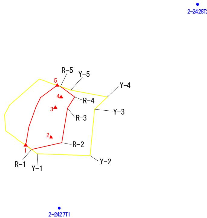
この図は、1/2500 地形図上で展開した、警戒区域・特別警戒区域について設定(基準)点及び下端(点)位置の実測(計測)値から、平坦部の範囲について推計(展開)したものである。
