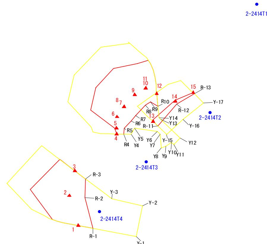
この図は、1/2500 地形図上で展開した、警戒区域・特別警戒区域について設定(基準)点及び下端(点)位置の実測(計測)値から、平坦部の範囲について推計(展開)したものである。
