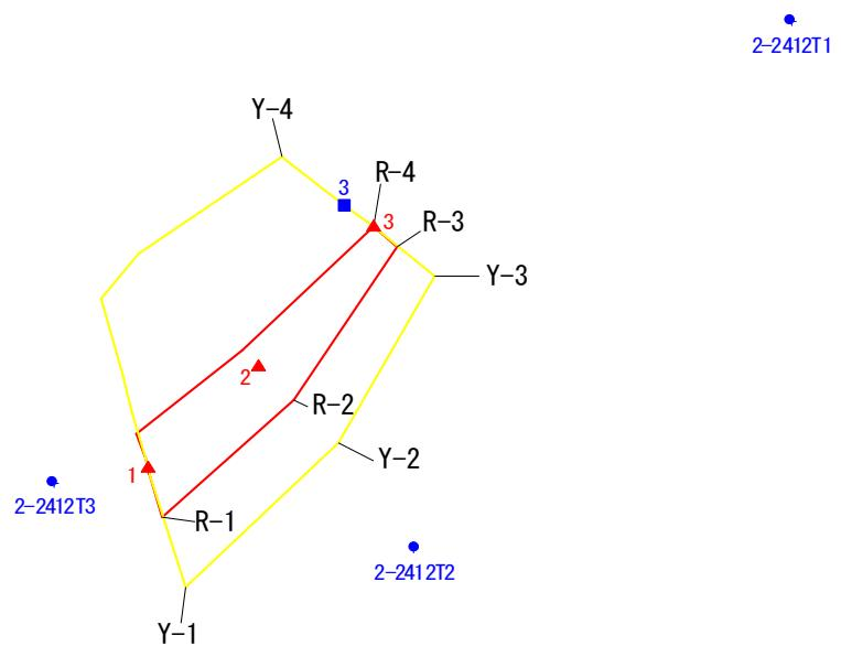
この図は、1/2500地形図上で展開した、警戒区域・特別警戒区域について設定(基準)点及び下端(上端)位置の実測(計測)値から、平坦部の範囲について推計(展開)したものである。
