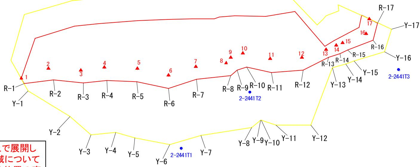
この図は、1/2500地形図上で展開した、警戒区域・特別警戒区域について設定(基準)点及び下端(点)位置の実測(計測)値から、平坦部の範囲について推計(展開)したものである。
