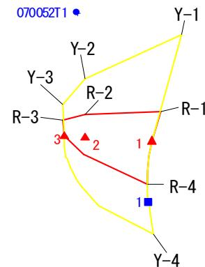
この図は、1/2500 地形図上で展開した、警戒区域・特別警戒区域について設定(基準)点及び下端(上端)位置の実測(計測)値から、平坦部の範囲について推計(展開)したものである。
