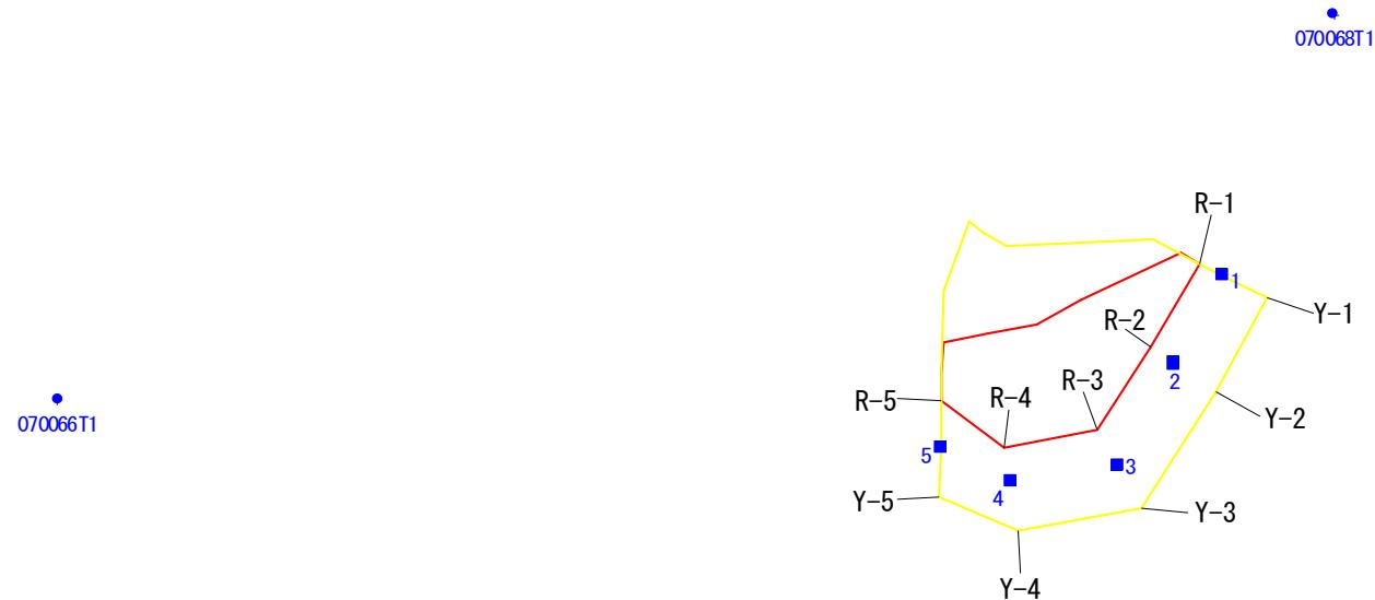
この図は、1/2500 地形図上で展開した、警戒区域・特別警戒区域について設定(基準)点及び下端(上端)位置の実測(計測)値から、平坦部の範囲について推計(展開)したものである。
