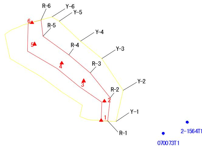
この図は、1/2500 地形図上で展開した、警戒区域・特別警戒区域について設定(基準)点及び下端(上端)位置の実測(計測)値から、平坦部の範囲について推計(展開)したものである。
